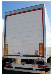
Roller shutter door
