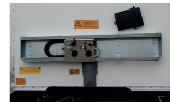
Système de coulissement latéral des têtes d'accouplement.
