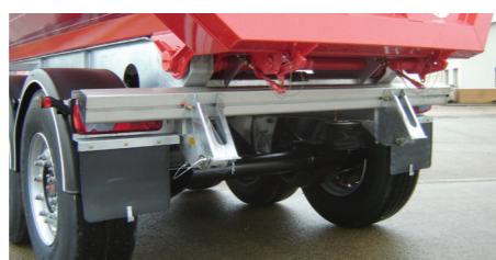
Pare-chocs hydraulique asservi au bennage
