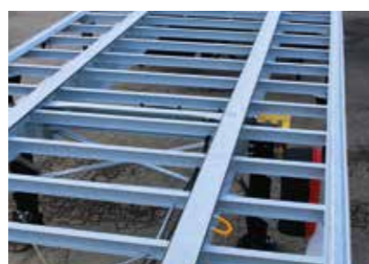
Plateau mécano soudé avec traverses en I au pas de 400 mm
