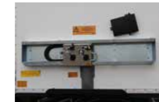
Système de coulissement latéral des têtes d'accouplement
