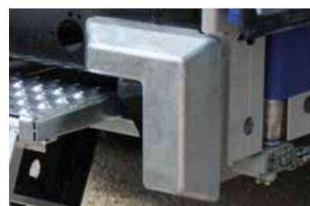
Protection intégrale de l'ensemble arrière par butoirs en acier galvanisé
