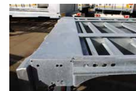
Dernière traverse proche de la traverse AR pour passage de chariots embarqués
