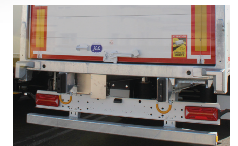
Cadre arrière renforcé pour mises à quai fréquentes
