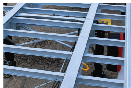
Plateau mécano-soudé avec traverses en I au pas de 400 mm
