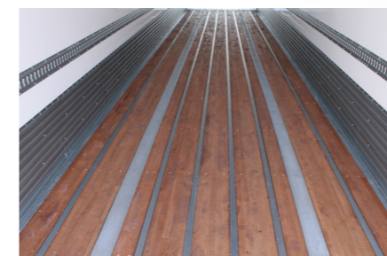
Plancher lamellé collé en bois dur de 35 mm avec omégas acier
