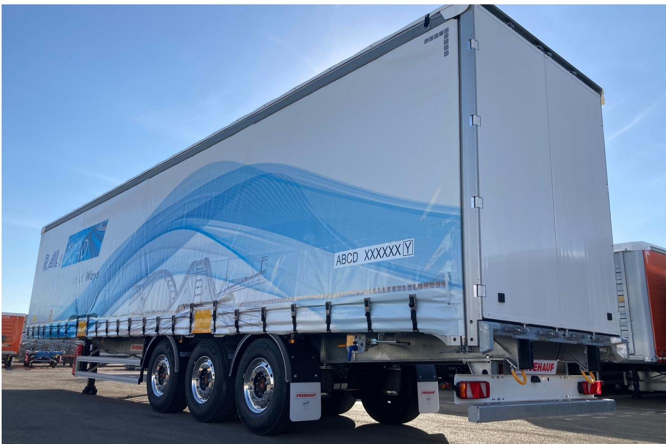
La solidité FRUEHAUF au service d'une performance de pointe : doté d'un châssis renforcé mécanosoudé, il est reconnu pour sa robustesse, garantissant fiabilité et longévité. Le châssis du RAIL&ROAD a été ainsi testé dans des conditions de charges extrêmes, résistant jusqu'à 40 tonnes de charge. D'un poids total de 6,6 tonnes, il est équivalent à celui du MAXISPEED CLASSIC.
