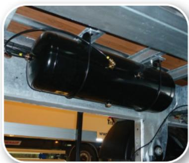
La porte relevante **EASYUP** peut être utilisée sans tracteur. L'adjonction d'un réservoir de servitude lui assure un nombre de cycle nettement supérieur aux besoins usuels entre 2 opérations de dételage et d'attelage.
