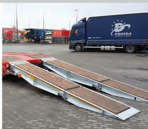
Rampes doubles pour un chargement en toute sécurité
