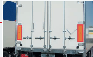
Portes renforcées à crémones extérieures
