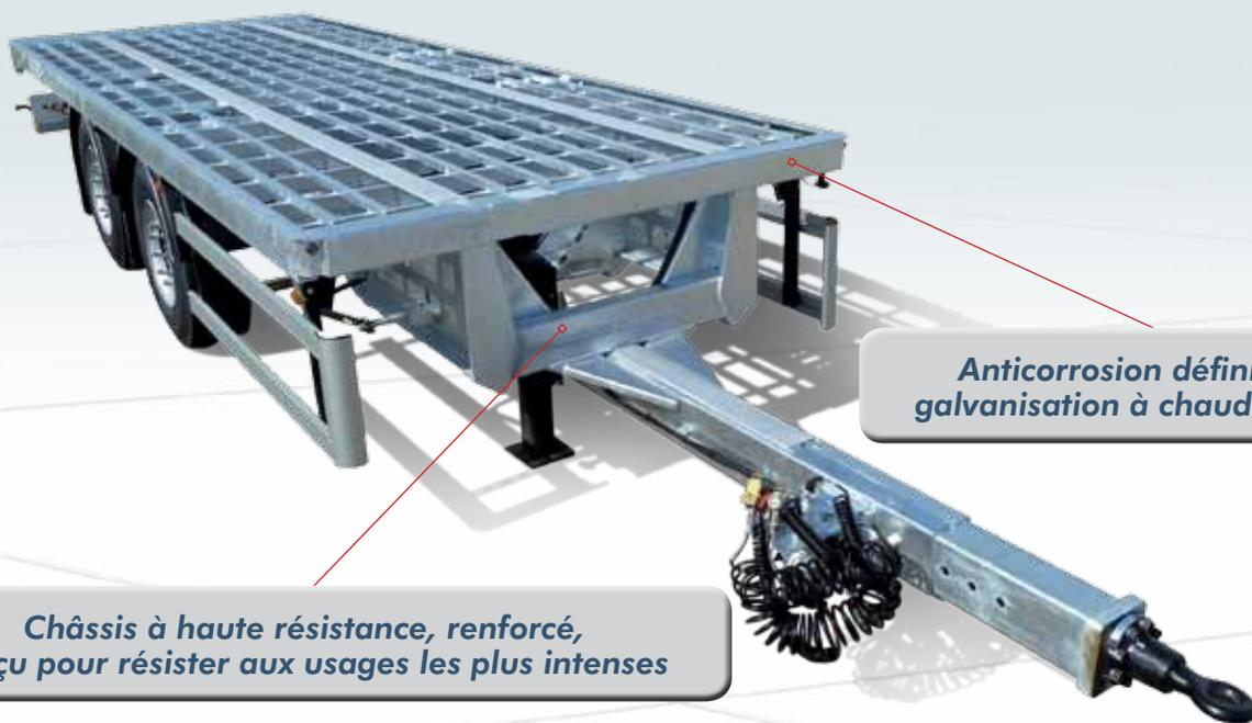
*Anticorrosion définitive par galvanisation à chaud au trempé*
