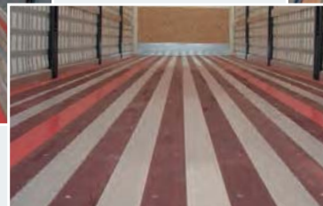
Mixte bois/alu pour une charge utile maximale
